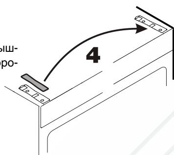
4. Переставьте защитную крышку на противоположную сторону.
