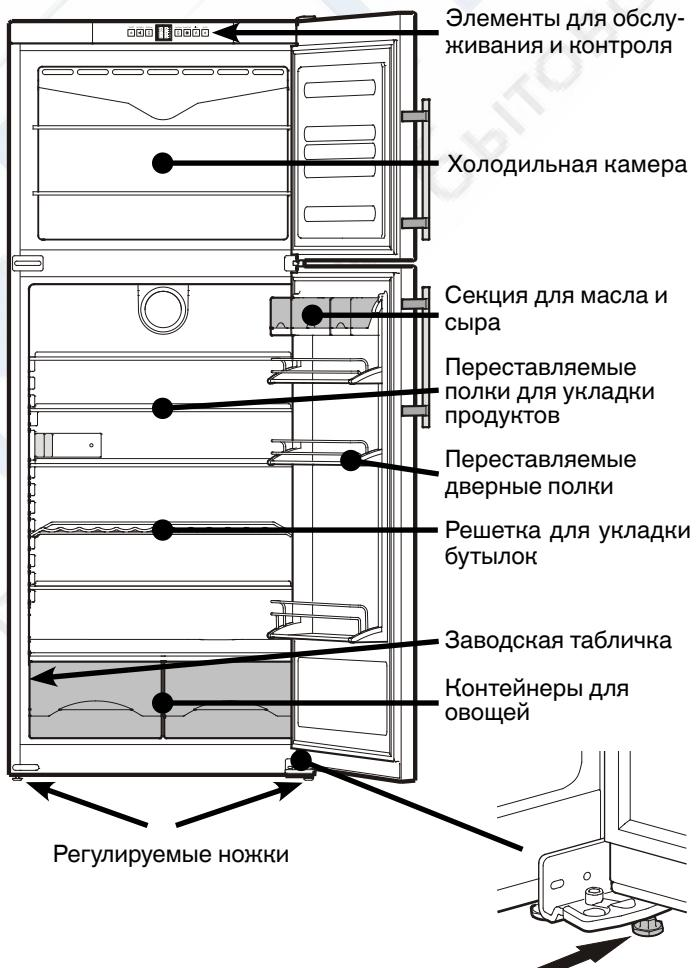
Выворачивайте регулируемую опору на опорном кронштейне до тех пор, пока она не будет опираться на пол, затем крутите далее по углом 90°.
