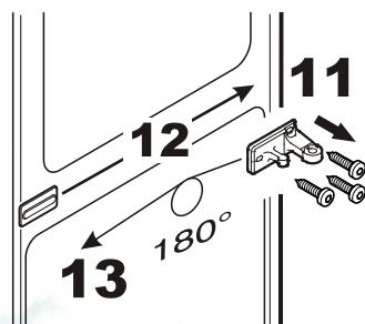
12. Переставьте защитную крышку на противоположную сторону.
