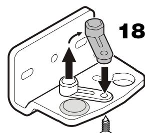
18. Переставьте опору шарнирного угла на противоположную сторону.
