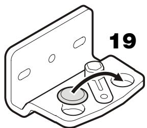
20. Переставьте защитную крышку на противоположную сторону.
